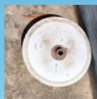
Parte inferior do balde com o furo e adaptador usando flange de 20mm.
