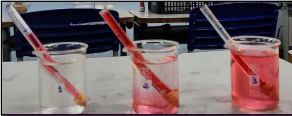
Resultado do experimento sobre a osmose realizado com tubos de caneta e membrana semipermeável (celulose). No tubo 1 o volume de líquido permaneceu estável (meio isotônico), no tubo 2 o volume aumentou (meio hipotônico) e no tubo 3 o volume diminuiu (meio hipertônico). À direita a membrana fixada com um elástico.
