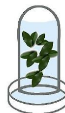
Figura 3: Ilustração da campânula de vidro invertida com água e material vegetal. Fonte: adaptado de Baker e Allen (1975), p. 185.
